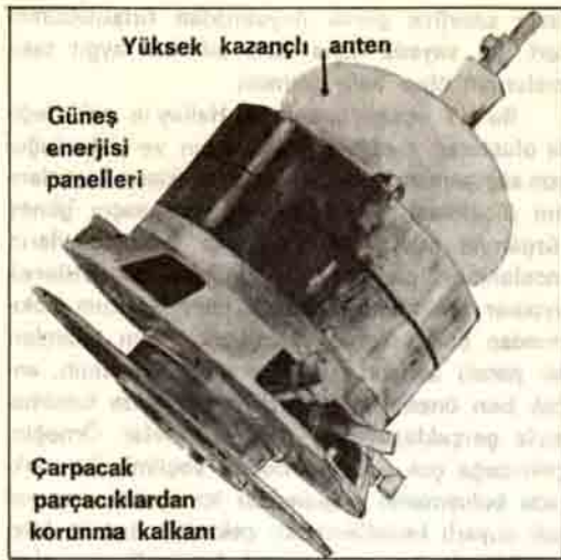
Avrupa Uzay Birliği (ESA) tarafından, Halley'i yakından incelemek üzere gönderilecek GIOTTO uzay sondası.
